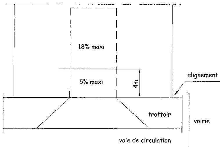
Les rampes d'accès sous-sol destinées aux véhicules, ne doivent pas avoir une pente supérieure à 18%. Au niveau du débouché sur voirie, et sur une distance de 4 m par rapport à l'alignement, la pente de la rampe ne doit pas excéder 5%
