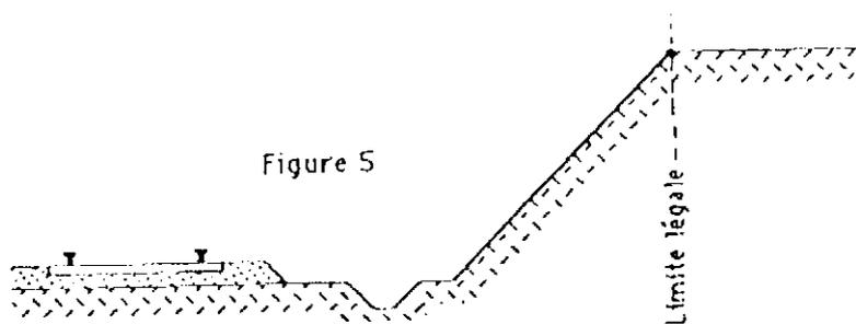
Dans le cas d'une voie posée à flanc de coteau, la limite légale à considérer est constituée par le point extrême des déblais ou remblais effectués pour la communication de la ligne et non la limite du talus naturel (figures 6 et 7).
