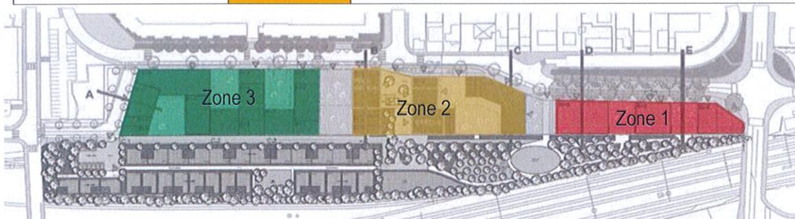
**Zone 1 :** Au regard des niveaux sonores estimés à partir des résultats de mesures vibratoires des points A et B, il semble nécessaire d'envisager la désolidarisation des bâtiments sensibles de cette zone (logements, ...) au moyen d'une coupure vibratoire très performante (boîte à ressort).
