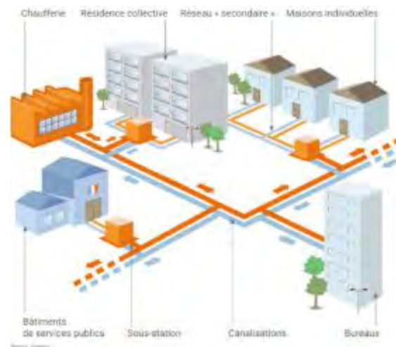
Figure 200 : Chaufferie centrale sur l'opération
