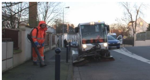
Balayage des voies accompagné du souffleur
