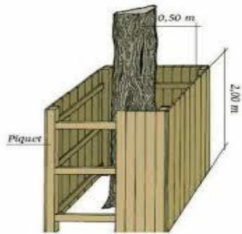
Protection du tronc à minima
