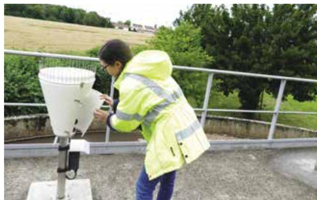
**Relevé des données d'un pluviomètre.**
