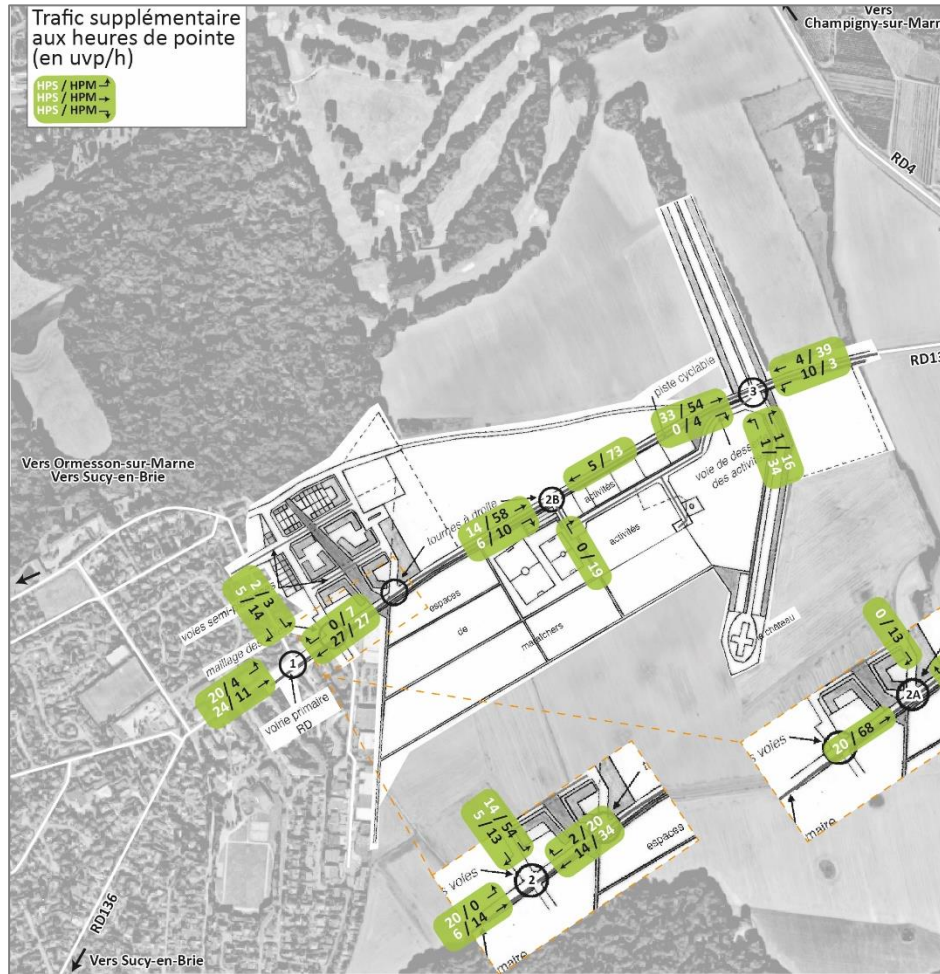
Figure 241 : Estimation des trafics supplémentaires de la ZAC agroéconomique aux heures de pointe
