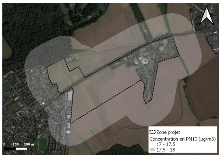
Figure 229 : Concentration en moyenne annuelle en PM10 dans la bande d'étude du projet en situation actuelle (source : IRIS Conseil)
