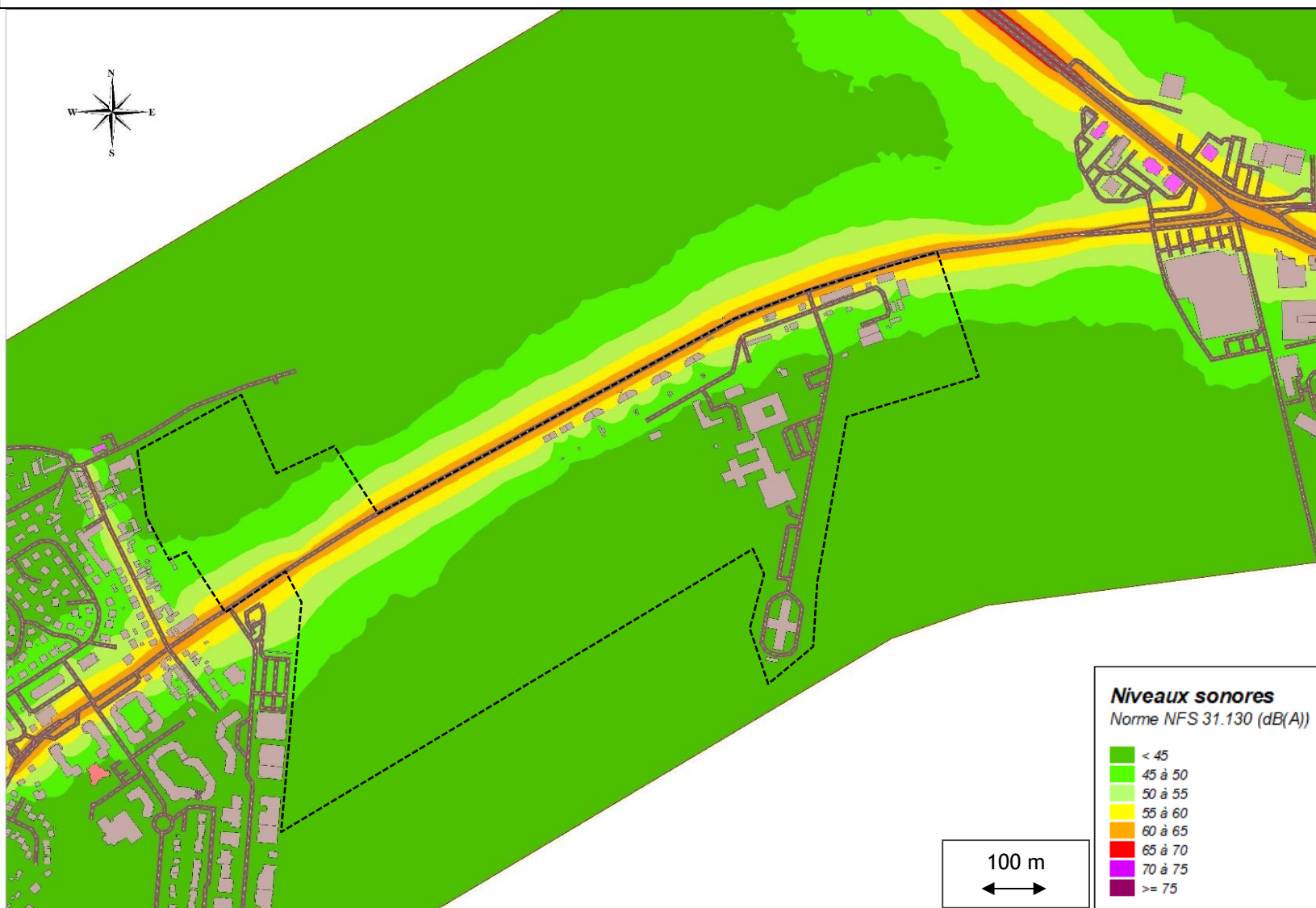
Situation sonore actuelle - Carte de bruit à 4 mètres du sol - Période nocturne LAeq (22h-6h)
