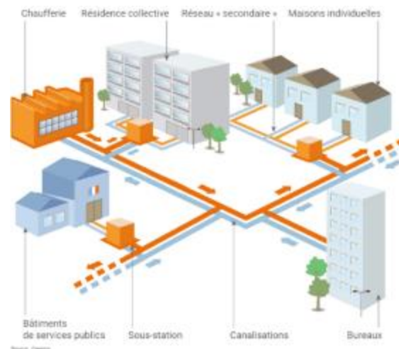
Figure 220 : Chaufferie centrale sur l'opération
